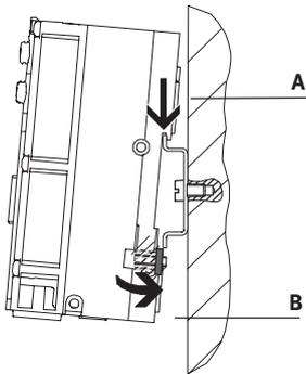
Im rückwärtigen Profil der CPX-Verkettungsblöcke ist die Hutschienenmontage eingepreßt. Über die Hutschienenbefestigungen läßt sich das CPX-Terminal auf der Hutschiene verriegeln.
