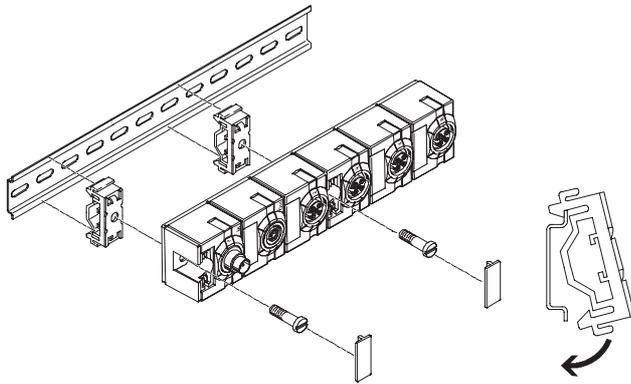
Für die CP-Module steht ein Befestigungssatz zur Verfügung, der auf eine Hutschiene aufgesetzt werden kann. Bei den kompakten Modulen sind die Montagebohrungen durch Bezeichnungsschilder abgedeckt.
