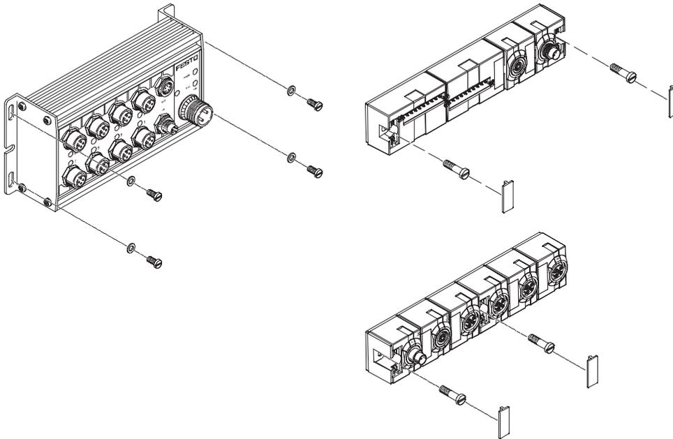
Über vorhandene Montagebohrungen lassen sich die CP-Module (mit Schrauben bis  $\varnothing 4$  mm) in nahezu jeder beliebigen Lage an ebenen Flächen montieren.
