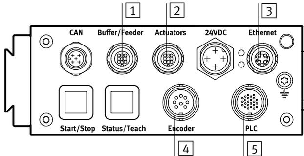
Fig. 3/1: The I/O module of the CHB-C-N
