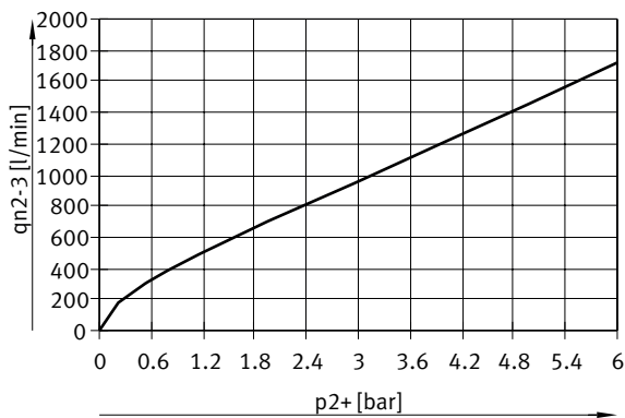
Durchfluss q_{n2-3} von 2 → 3 in Abhängigkeit vom Ausgangsüberdruck p_{2+} , VPPM-8L/F-...-0L6H-... (6 bar)
