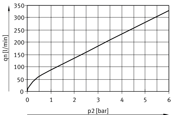
Durchfluss q_n in Abhängigkeit vom Ausgangsdruck p_2 , VPPE-3-1-1/8-6-..., q_n 2 -> 3
