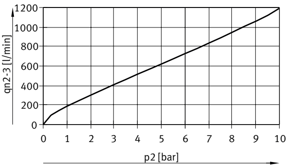
Caudal qn de 2 -> 3 en función de la sobrepresión de salida p2, VPPM-6L/F-...-0L10H-... (10 bar)
