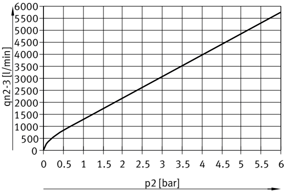
Caudal qn de 2 -> 3 en función de la sobrepresión de salida p2, VPPM-12L-...-0L6H-... (8 bar)
