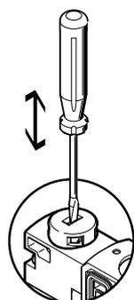
El accionamiento manual auxiliar se acciona presionando con un pasador o un destornillador y regresa a su posición mediante la fuerza del muelle (la posición con enclavamiento se evita mediante la tapa ciega codificada).
