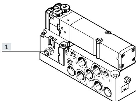
[1] Conexión eléctrica, conector de 4 pines, M8, según EN 60947-5-2
