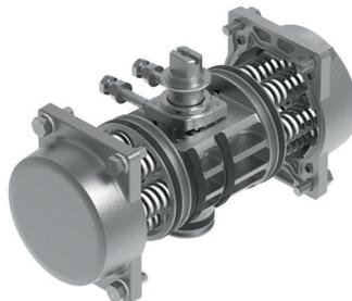
En el caso del actuador giratorio de simple efecto, el aire comprimido entrante mueve el émbolo en una dirección. Esto genera el momento de giro del actuador. Simultáneamente, los muelles instalados en el actuador se pretensan. La fuerza del muelle genera el momento de giro en el sentido de giro opuesto cuando las cámaras de presión del actuador se descargan. De esta forma, las válvulas de proceso se mueven hacia la posición inicial requerida.
