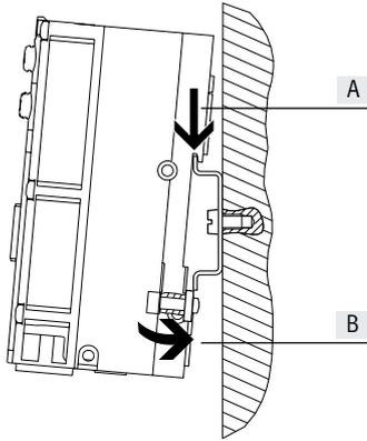
En el perfil trasero de los módulos de encadenamiento CPX-P se encuentra el sistema de montaje en perfil DIN. El terminal CPX-P puede bloquearse en el perfil DIN mediante las fijaciones para perfil DIN.
