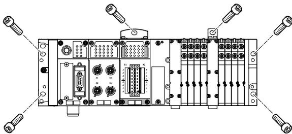
Las placas finales del terminal CPX-P y del terminal de válvulas y la interfaz neumática están provistas de taladros de fijación para el montaje mural. Si los terminales de válvulas son más largos, puede recurrirse a las fijaciones adicionales para el terminal CPX-P.
