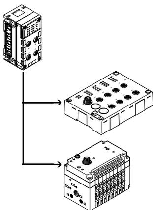
La conexión eléctrica CPX-CTEL-2-... permite conectar módulos con interfaz IO-Link (dispositivo IO-Link) al terminal CPX-P. Los datos de entrada/salida de los dispositivos conectados son transmitidos a los nodos de bus CPX-P conectados y, de esta manera, al control de nivel superior mediante el bus de campo.
