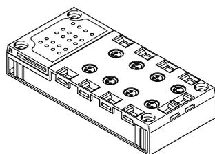
Montaje directo en la máquina (bloque de conexión con grado de protección IP65/IP67)
