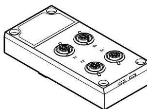
Montaje directo en la máquina (bloque de conexión con grado de protección IP65/IP67)
