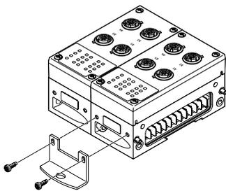
Tratándose de terminales de válvulas más largos, puede recurrirse a escuadras de fijación adicionales para el terminal CPX-P que se atornillan a los módulos de encadenamiento.
