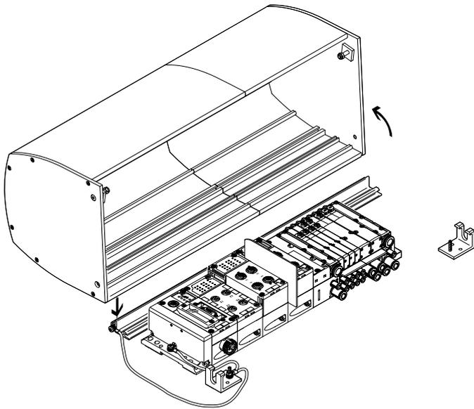
La caperuza CAFC para terminales CPX constituye una alternativa compacta y económica a los armarios de maniobra. Está fabricada como perfil de aluminio extrusionado y se instala sobre una placa de montaje.
