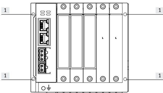
Die Verkettungsplatte verfügt über vier Durchgangsbohrungen [1] für die Montage der Ventilinsel.
