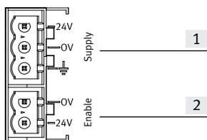
Die Ventilinsel besitzt einen Anschluss zur Spannungsversorgung für Elektronik und Ventile [1].
