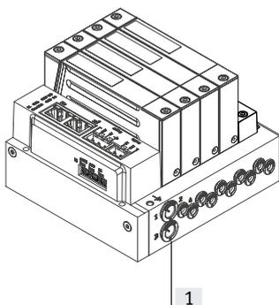
Die Ventilinsel VTEP wird über die Anschlüsse [1] in der Verkettungsplatte mit Druck versorgt.
