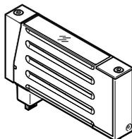
VTEP bietet zwei unterschiedliche Ventile, einmal für hohen Druck und einmal für niedrigen Druck. Die Ventile bestehen aus vier zu einer Vollbrücke verschalteten 2/2 Wege-Proportionalventilen, von denen je zwei den Druck in Kanal 2 und zwei den Druck in Kanal 4 regeln.
