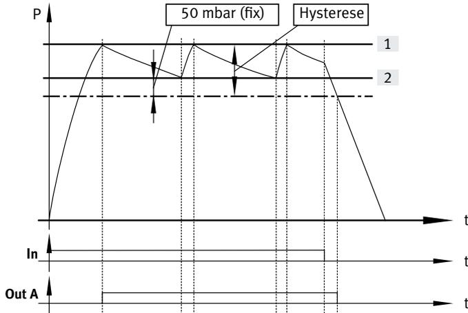
Ist der gewünschte Schwellwert [1] für das Vakuum erreicht, wird die Vakuumerzeugung selbstständig ausgeschaltet. Ein Rückschlagventil verhindert den Abbau des Vakuums.
