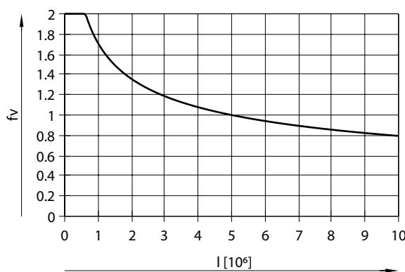
Die Lebensdauer der Führung ist von der Belastung abhängig. Um eine Aussage über die Lebensdauer treffen zu können, wird im nachfolgenden Diagramm als Kenngröße der Belastungs-Vergleichsfaktor  $f_v$  im Bezug auf die Lebensdauer dargestellt.
