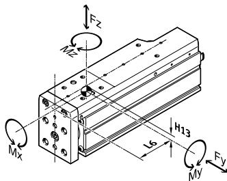
Die angegebenen Kräfte und Momente beziehen sich auf die Führungsmitte. Der Angriffspunkt ist der Schnittpunkt aus Führungsmitte und Längenmitte des Schlittens. Sie dürfen im dynamischen Betrieb nicht überschritten werden. Dabei muss besonders auf den Abbremsvorgang geachtet werden.
