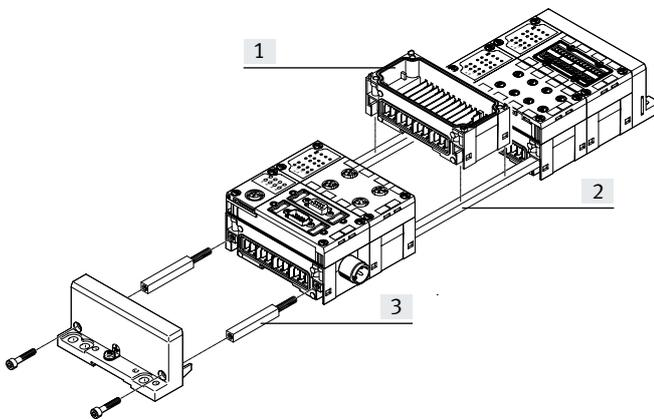
Die CPX-Module werden mit speziellen Zugankern [2] mechanisch miteinander verbunden. Die Befestigung erfolgt mit nur zwei Schrauben in den Endplatten für die gesamte Einheit. Der Zuganker gewährleistet eine hohe mechanische Belastbarkeit der Einheit und ist somit das „Mechanische Rückgrat“ des CPX-Terminals.
