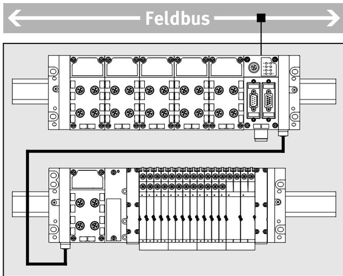
Die Extension ermöglicht die Auftrennung bzw. Konfiguration des CPX-Terminals in zwei miteinander verbundene Einheiten (Reihen). Die Ansteuerung beider Teile erfolgt über einen gemeinsamen Busknoten bzw. Steuerblock. Dadurch wird ermöglicht, ein umfangreiches CPX-Terminal in Form zweier kompakterer Einheiten besser an begrenzte Einbauräume anzupassen.
