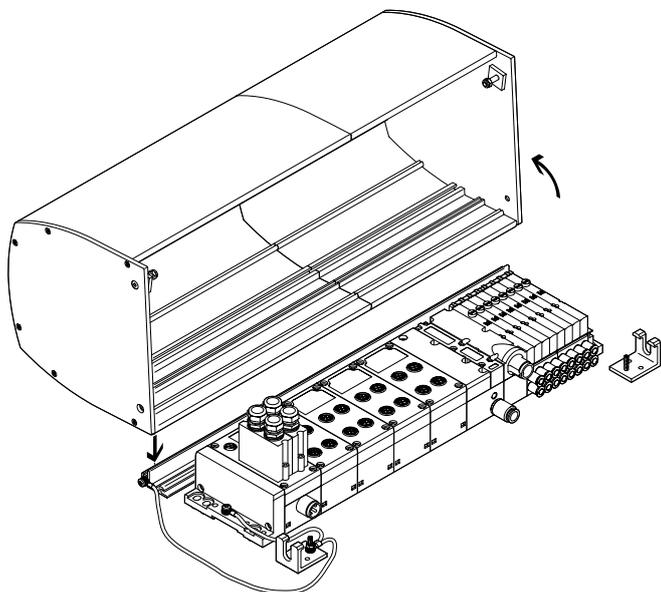
Die CPX-Haube CAFC ist eine platz- und kostensparende Alternative zu einem Schaltschrank. Sie ist als Aluminium-Strangpressprofil ausgeführt und wird auf einer Montageplatte installiert. Die Ventilinsel (CPX mit MPA-S oder MPA-L) ist geschützt aufgebaut und schnell installiert, ohne aufwendige Schaltschrankdurchführung für Verbindungsleitungen und Schläuche.
