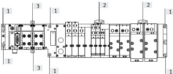
In den Endplatten des CPX-Terminals, der Ventilinsel und im Pneumatik-Interface sind Befestigungslöcher [1] für die Wandmontage vorgesehen. Für längere Ventilinseln stehen zusätzliche Befestigungen [2] für das CPX-Terminal zur Verfügung.
