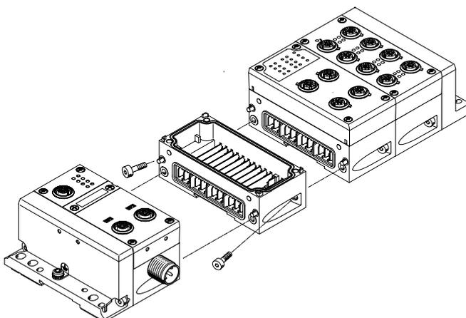
Die CPX-Module werden durch eine Schrägverschraubung mechanisch miteinander verbunden. Das CPX-Terminal ist so jederzeit flexibel erweiterbar.
