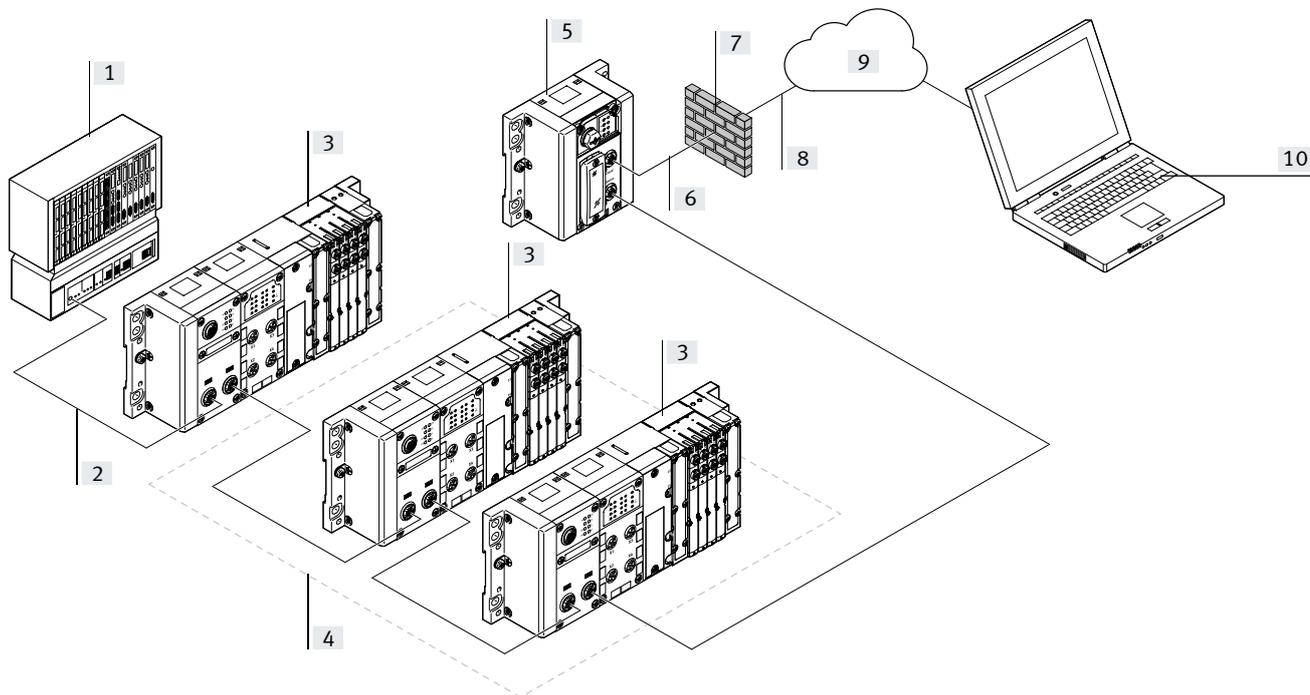
[1] SPS zur Maschinen-/Anlagensteuerung (besitzt keine direkte Internetanbindung)
