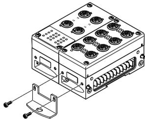
Für längere Ventilinseln stehen zusätzliche Befestigungswinkel für das CPX-Terminal zur Verfügung, die an den Verkettungsblöcken angeschraubt werden können. Der Befestigungswinkel CPX-M-BG-VT-2X ermöglicht die Befestigung eines CPX-Terminals mit Ventilinsel VTSA/VTSA-F/VTSA-F-CB auf einem Trägersystem.
