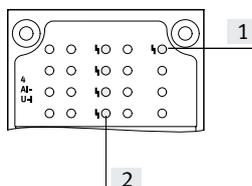
[1] Fehler-LED (rot; Modulfehler)
