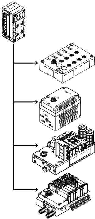
Die Elektrik-Anschaltung CPX CTEL-Master erstellt die Verbindung zu Modulen mit I-Port Schnittstelle (Device) der CTEL/CTEU-Familie. Die E/A-Daten der angeschlossenen Devices werden an den angeschlossenen CPX-Busnoten und somit über Feldbus an die übergeordnete Steuerung übertragen. Über entsprechende M12-Schnittstellen können maximal 4 Devices an einen CPX CTEL-Master angeschlossen werden.
