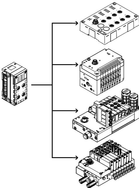
Der CPX CTEL-Master stellt nach außen 4 I-Port Schnittstellen bereit, an die jeweils ein Device angeschlossen werden kann. I-Port ist eine Schnittstelle für den Austausch serieller Daten zum Anschluss von dezentralen Modulen oder Ventilinseln von Festo. Die I-Port Schnittstelle basiert auf IO-Link und ist in bestimmten Bereichen damit kompatibel. Die Verbindungsart entspricht einer Stern-Topologie. Das heißt, es kann an jeden I-Port nur ein Modul oder eine Ventilinsel angeschlossen werden.
