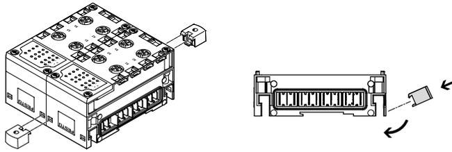
Für längere Ventilinseln stehen zusätzliche Befestigungen für das CPX-Terminal zur Verfügung, die jeweils zwischen zwei Modulen angebracht werden können.
