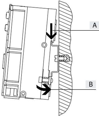
Im rückwärtigen Profil der CPX-Verkettungsblöcke ist die Hutschiennenmontage eingepreßt. Über die Hutschiennenbefestigungen lässt sich das CPX-Terminal auf der Hutschiene verriegeln. Das Terminal CPX wird dazu in die Hutschiene eingehängt (siehe Pfeil [A]).
