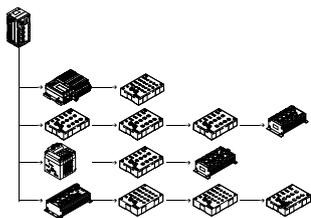
Die Elektrik-Anschaltung CPX CP-Interface erstellt die Verbindung zu CP-Modulen des Installationssystem CPI über fertig konfektionierte Verbindungsleitungen. Die E/A-Daten der angeschlossenen Ventilinseln mit CP-Strangerweiterung und CP-Ein- und Ausgangsmodule werden an den angeschlossenen CPX-Busnoten und somit über Feldbus an die übergeordnete Steuerung übertragen. Damit lassen sich modulare zentrale und kompakte dezentrale Konzepte mit einem System aufbauen.
