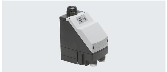
Kondensat gelangt durch die Anschlussbohrung im Boden der Filterschale in das angebaute Kondensatablassventil und wird dort in einem Behälter gesammelt. Wenn der maximale Füllstand erreicht ist, erkennt dies ein kapazitiver Sensor.
