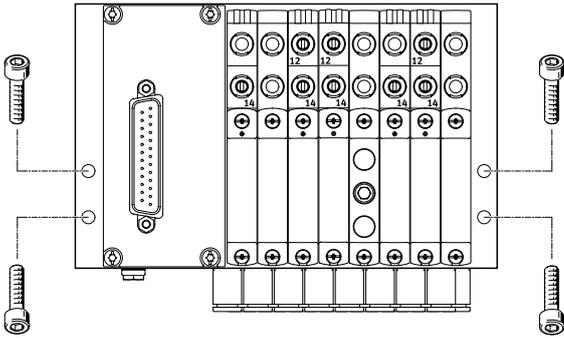
Die VTUG Ventilinsel mit vier M4-Schrauben auf der Befestigungsfläche fixieren.
