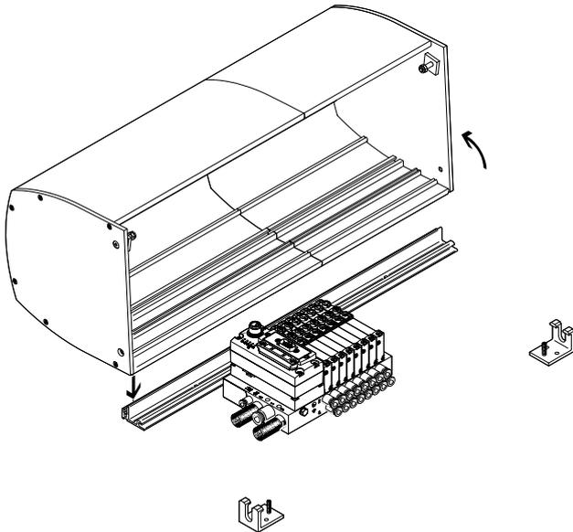
Die VTUG-VI-EX2-Haube CAFC ist eine platz- und kostensparende Alternative zu einem Schaltschrank. Sie ist als Aluminium-Strangpressprofil ausgeführt und wird auf einer Montageplatte installiert. Die Ventilinsel ist geschützt aufgebaut und schnell installiert, ohne aufwendige Schaltschrankdurchführung für Verbindungsleitungen und Schläuche.
