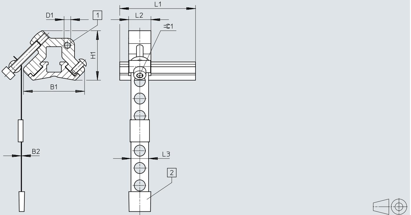
[1] Befestigungsgewinde für Näherungsschalter SM ... O-8E
