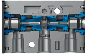
Ein pneumatisches Vorsteuerventil, dessen Konstruktionsprinzip ein Sitzventil ist, wird über die NAMUR Schnittstelle direkt am Schwenkantrieb montiert. Das Sitzventildesign spielt seine Vorteile aus, wenn die Ansprüche an die Anwendung sich erhöhen. Die Vorteile sind die bessere Verträglichkeit gegen „verschmutzte“ Druckluft, eine geringere Leckage und weniger dynamische Dichtungen, was sich auf die Lebensdauer auswirkt.
