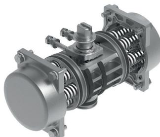
Beim einfachwirkenden Schwenkantrieb bewegt die einströmende Druckluft die Kolben in eine Richtung. Damit wird das Drehmoment des Antriebs erzeugt. Gleichzeitig werden die, im Antrieb eingebauten, Federn vorgespannt. Diese Federkraft erzeugt das Drehmoment in die entgegengesetzte Drehrichtung, wenn die Druckkammern des Antriebs entlüftet werden. Dadurch bewegt sich die Armatur in die geforderte Grundstellung.
