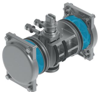
Der doppelwirkende Schwenkantrieb benötigt für jede Bewegungsrichtung Druckluft. Bei dieser Funktionsweise wird das Drehmoment für das Öffnen oder Schließen der Armatur rein über die Druckluft aufgebaut.
