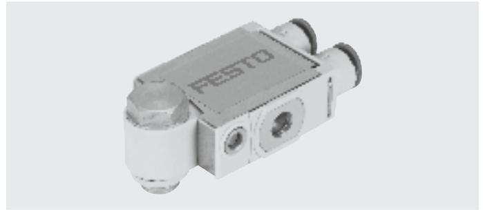
La válvula de estrangulación y antirretorno VFOF-LE-BAH es una válvula que combina la función de estrangulación de aire de escape con antirretorno de aire de escape con antirretorno desbloqueable y de descarga de aire manual. La función de estrangulación y antirretorno del aire de escape se utiliza para
