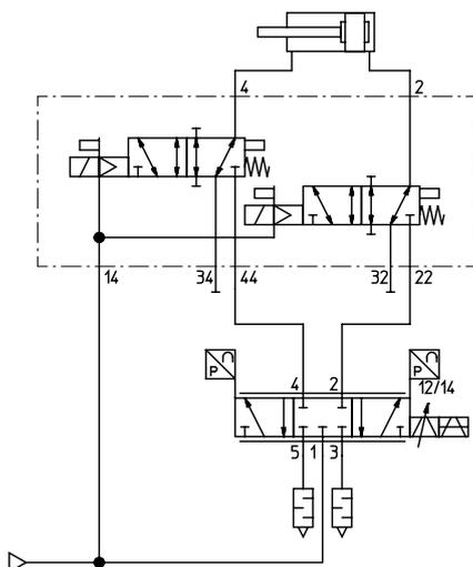
Las 4 funciones de desconexión monocanal diferentes pueden configurarse a través de las conexiones de función 32 (A) y 34 (B):
