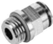
Racor metálico de latón macizo, niquelado químicamente. Resistencia a la corrosión elevada CRC 3 y a las sustancias químicas. Para aplicaciones neumáticas con un margen de temperatura de hasta 150 °C y un margen de presión de hasta 20 bar.
