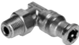
Racor rápido roscado de acero inoxidable. Máxima clase de resistencia a la corrosión CRC 4 y a sustancias químicas; con certificación para la industria alimentaria y del envasado. Para aplicaciones neumáticas con un margen de temperatura de hasta 120 °C y un margen de presión de hasta 10 bar. Diámetro exterior de tubo flexible de 4, 6, 8, 10, 12 y 16 mm con rosca de conexión M5 y R1/8 ... R1/2.
