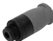
Racor de plástico para una instalación sencilla gracias al manejo con una sola mano. Resistente a la hidrólisis, conforme con las especificaciones de la FDA y de fácil limpieza. Para aplicaciones neumáticas con un margen de temperatura de hasta 60 °C y un margen de presión de hasta 10 bar.
