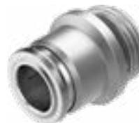
Racor rápido roscado de acero inoxidable. Máxima resistencia a la corrosión CRC 4 y a sustancias químicas. Para aplicaciones neumáticas con un margen de temperatura de hasta 150 °C y un margen de presión de hasta 16 bar. Diámetro exterior de tubo flexible de 4, 6, 8, 10 y 12 mm con rosca de conexión M5, M7 y G1/8 ... G1/2.
