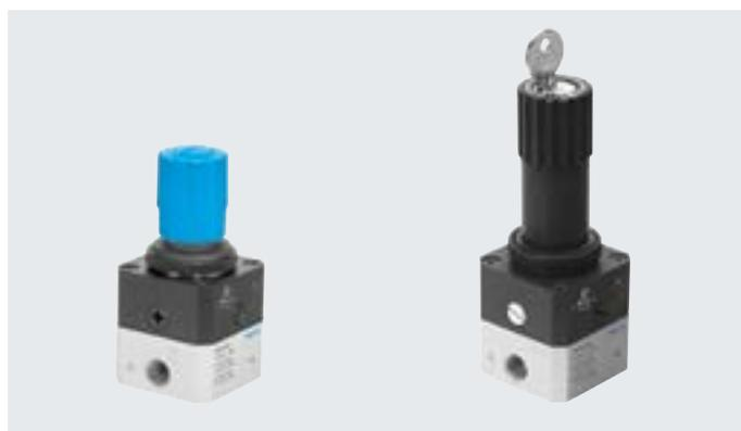
El regulador de presión de precisión permite regular la presión de funcionamiento (lado secundario) mediante un servopilotaje de diafragma que actúa sobre el asiento principal, con lo que se consigue una característica de regulación mejor.
