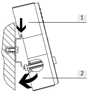
En el perfil trasero de los módulos CP económicos se encuentra el sistema de montaje en perfil DIN. Los módulos pueden fijarse en el perfil DIN mediante los accesorios para montaje en perfil DIN.
