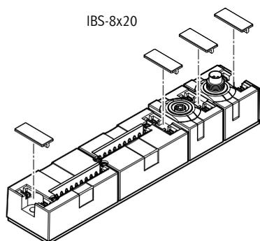
Los módulos CP compactos cuentan para cada conexión con una fijación para una placa de identificación IBS-8x20 (n.º de art. 539388).
