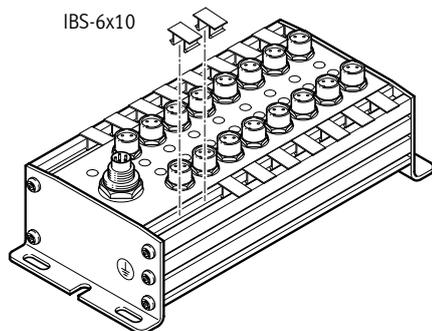
Los módulos CP robustos disponen de dos ranuras para montar las placas de identificación IBS-6x10 (n.º de art. 18576). Puede montarse como mínimo una placa de identificación en cada conexión.
