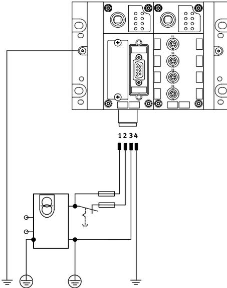
La utilización de equipos descentralizados conectados al bus de campo, especialmente con alto grado de protección para el montaje directo en la máquina, exige un concepto flexible de alimentación eléctrica. El terminal CPX permite conectar cualquier potencial a través de una conexión.
