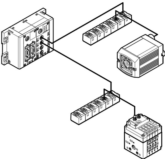
El sistema de cámara compacta SBOx-Q puede integrarse en una red CPI de Festo. En ese caso, funciona con un módulo binario con 16 entradas y salidas.
