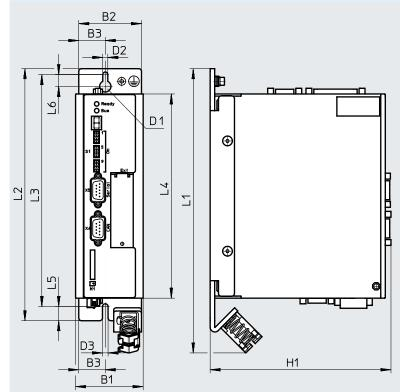
B1 B2 B3 D2 Η1 Туре D1 D3 Ø Ø Ø 24 10 4.5 5 CMMS-ST 60 56 161 L1 L2 L3 L4 L6 Туре L5 CMMS-ST 252 224 206.25 181 12.5 15.75
