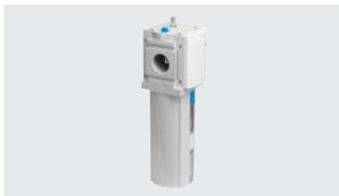
Der Proportional-Öler führt der Druckluft eine fein dosierbare Ölmenge zu. Das Druckgefälle, das beim Durchströmen einer Venturidüse entsteht, wird benützt, um aus einem Behälter Öl bis zur Abtropfkappe zu fördern.
