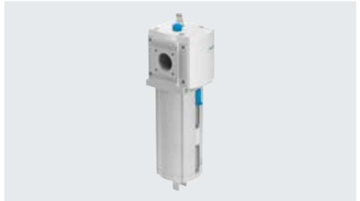
Der Proportional-Öler führt der Druckluft eine fein dosierbare Ölmenge zu. Das Druckgefälle, das beim Durchströmen einer Venturidüse entsteht, wird benützt, um aus einem Behälter Öl bis zur Abtropfkappe zu fördern.
