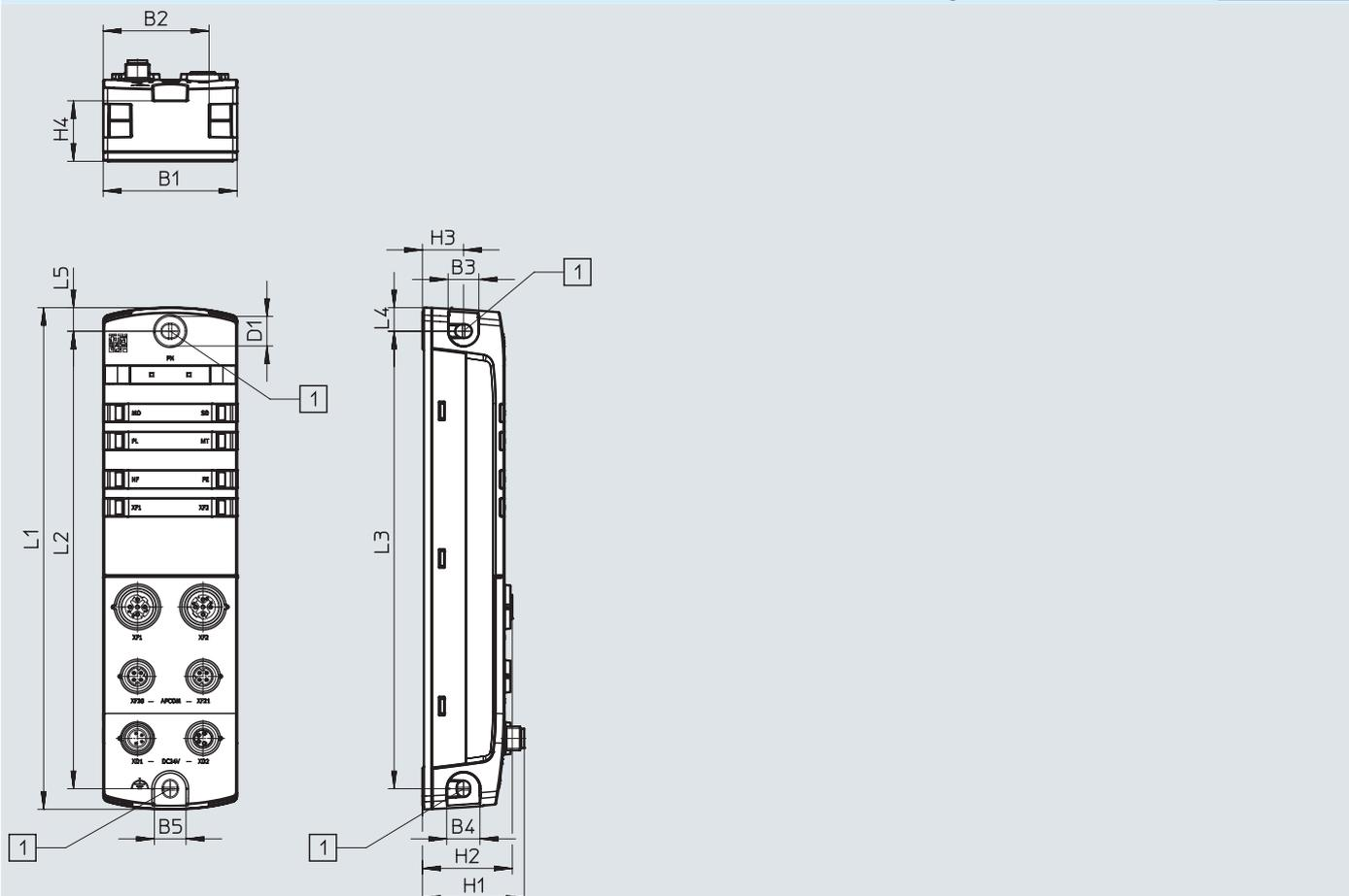
[1] Trous de fixation pour vis M4
