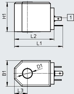
[1] Esquema de conectores forma A, según EN 175301-803
