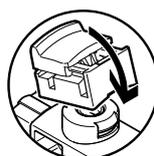
HHB mit Arretierung auf Vorsteuerventil aufclipsen. Danach kann die Kappe der HHB rastend ohne Werkzeug betätigt werden.
