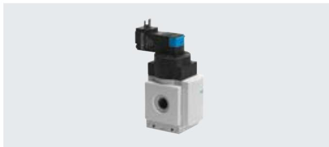
Die Dauer des Druckaufbaus wird über die am Ventildeckel angebrachte Drossel eingestellt. Entsprechend der eingestellten Drosselstellung steigt der Ausgangsdruck p<sub>2</sub> langsam an. Solange das Magnetventil nicht betätigt wird, steht nur der Durchfluss der Drossel zur Verfügung. Erst durch Bestromen des Magnetventils wird der Hauptsitz geöffnet.
