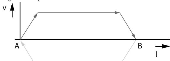
Rozšířený profil pohybů pro zjednodušenou funkci lisování a sevření: regulována rychlosť nebo síla
