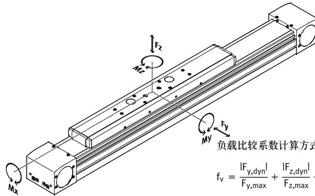
如果电缸同时受到图中所示力和扭矩的作用，除了所示最大负载外，还必须满足以下等式：
