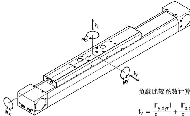
如果电缸同时受到图中所示力和扭矩的作用，除了所示最大负载外，还必须满足以下等式：
