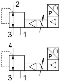
Die modellbasierte Proportional-Druckregelung ermöglicht an Kanal 2 und Kanal 4 voneinander unabhängige, geregelte Drücke zur Verfügung zu stellen. Die integrierten Sensoren ermöglichen eine präzise Überwachung des Druckes.
