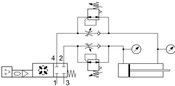
Für die Kanäle 2 und 4 kann jeweils unabhängig voneinander ein gewünschter Sollwert vorgegeben werden. Das Motion Terminal VTEM reguliert den Druck selbsttätig und signalisiert der übergeordneten Steuerung den real in Kanal 2 und Kanal 4 anliegenden Druck.
