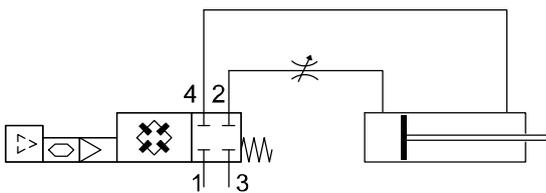
Für eine energiesparende Zylinderbewegung wird bei ungedrosselter Entlüftung der Zylinder mit gedrosselter Zuluft ausgefahren. Bei Erreichung der Endlage wird die Zuluftseite gesperrt, Druckniveau und Zylinderposition werden so gehalten.
