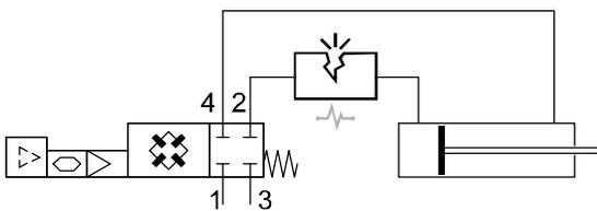
Für die Berechnung der Leckage wird der Druckabfall an einem Ventil (Antrieb in Endlage) ermittelt. Um den ermittelten Wert bewerten zu können, wird über eine Messung zu Beginn des Beobachtungszeitraumes ein Referenzwert ermittelt. Das Motion Terminal VTEM vergleicht den Wert aus weiteren Messungen mit diesem Referenzwert. Aus diesem Vergleich erfolgt eine
