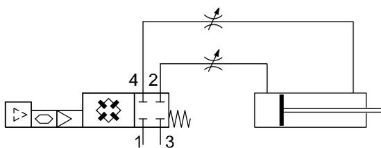
Für jeden Kanal lässt sich der Durchfluss individuell einstellen, Zuluft- und Abluftdrosselung werden unabhängig voneinander
