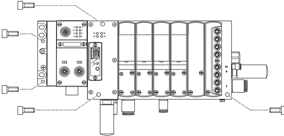
Das Motion Terminal VTEM wird mit fünf M4- oder M6-Schrauben auf der Befestigungsfläche angeschraubt.
