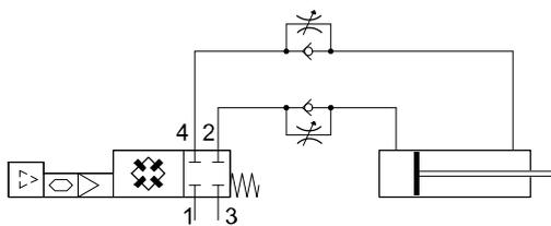
Dem Motion Terminal VTEM wird die Verfahrzeit für das Ein- und Ausfahren vorgeben. Selbständig wird anhand der Sensordaten der Endlagenschalter die reale Verfahrzeit ermittelt und die Abluftdrosselung angepasst, bis die vorgegebene Verfahrzeit erreicht wird. Die Überwachung und Anpassung erfolgen permanent, so dass Ver-
