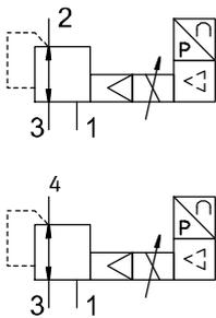
Die Proportional-Druckregelung ermöglicht an Kanal 2 und Kanal 4 voneinander unabhängige, geregelte Drücke zur Verfügung zu stellen
