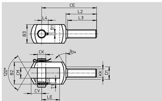
Der Gabelkopf SGA 1 dient in Verbindung mit dem Gelenkkopf SGS 2 (→ Seite 4) zur sphärischen Befestigung von Zylindern.
