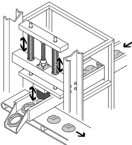
Mit dem Muskel sind sehr hohe Taktraten erreichbar. Einerseits aufgrund seines geringen Gewichts. Andererseits, weil er ohne bewegliche Teile wie z. B. einem Kolben auskommt. Der einfache Aufbau – ein Muskel über zwei Federn vorgespannt – ersetzt ein kompliziertes Kniehebel-Spannsystem mit Zylindern.
