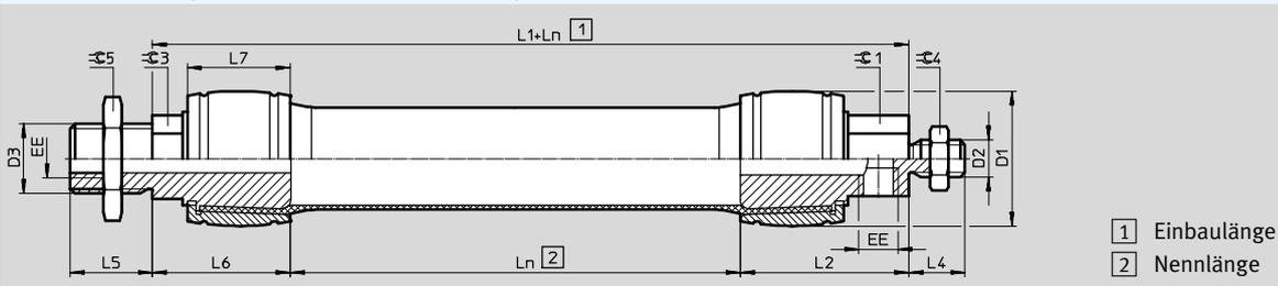
DMSP-...-AM-CM – pneumatischer Anschluss axial – kein Anschluss, mit Außengewinde
