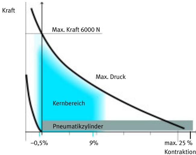
Der Muskel wird in die Länge gezogen, wenn er durch eine äußere Kraft vorgereckt wird. Bei Druckbeaufschlagung erfolgt dagegen eine Kontraktion des Muskels, d. h. seine Länge verkürzt sich.
