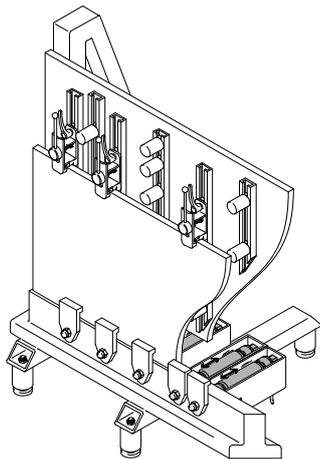
Der Pneumatische Muskel ermöglicht ein einfaches Spannen von großen und unhandlichen Werkstücken, wie Platten, Wände, Seitenteile, welche mechanisch bearbeitet werden (Drehen, Bohren, Fräsen). Hierbei kommen die herausragenden Eigenschaften des Muskels, wie hohe Kraft bei kleinem Durchmesser, reibungsfreie und damit ruckfreie Bewegungen, Unempfindlichkeit gegenüber Schmutz (Späne, Abrieb) und seiner hermetisch dichten Bauweise, zum Tragen.
