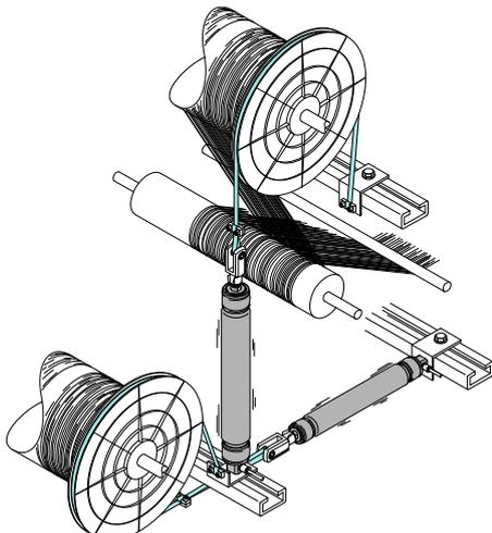
Die Federeigenschaften des Pneumatischen Muskels eignen sich sehr gut zur Regelung der Fadenspannung beim Abwickeln von Fäden. Die Spannung des Fadens ist immer so groß, wie sie für den jeweiligen Prozess benötigt wird. Damit steht immer die optimale Fadenspannung zur Verfügung, wodurch eine größere Schonung der Fäden erzielt und dem Verschleiß aller Bauteile entgegengewirkt wird.
