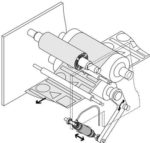
Hervorragend eignet sich der Pneumatische Muskel zum Andrücken von Walzen. Über den Betriebsdruck kann der Anpressdruck variiert werden. Aufgrund der Bauweise kommt es zu keinen feststehenden Bauteilen und somit zu keinen Kraftspitzen. Der Pneumatische Muskel ist hermetisch dicht und kann von der Druckluftversorgung getrennt werden. Trotzdem erfüllt er weiterhin seine Funktion.
