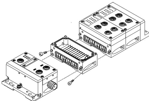
Die CPX-P-Module werden durch eine Schrägverschraubung mechanisch miteinander verbunden. Das CPX-P-Terminal ist so jederzeit flexibel erweiterbar.
