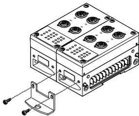
Für längere Ventilinseln stehen zusätzliche Befestigungswinkel für das CPX-P-Terminal zur Verfügung, die an den Verkettungsblöcken angeschraubt werden können.
