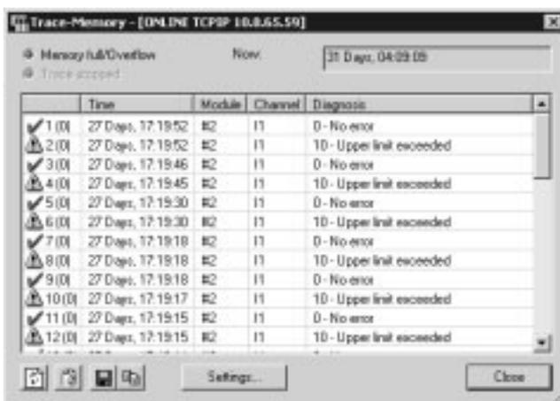
Im Betrieb auftretende Fehler werden in einen Diagnosespeicher eingetragen. Gespeichert werden die ersten oder die letzten 40 Einträge, sowie der jeweilige Zeitpunkt, gemessen ab dem Einschalten der Spannungsversorgung.
