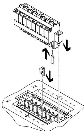
Die Anschlussblöcke CPX-P-AB-2XKL-8POL und CPX-P-AB-2XKL-8POL-8DE-N-IS, und die Dosen NECU-L3G8, können mit den Kodierstücken CPX-P-KDS-AB-2XKL einander zugeordnet werden.
