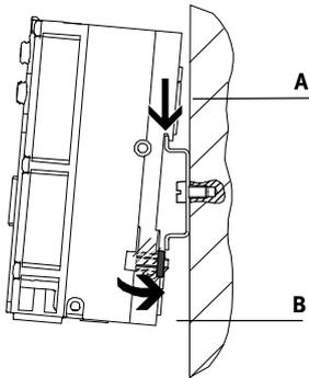
Im rückwärtigen Profil der CPX-P-Verkettungsblöcke ist die Hutschienenmontage eingepreßt. Über die Hutschienenbefestigungen lässt sich das CPX-P-Terminal auf der Hutschiene verriegeln. Das Terminal CPX-P wird dazu in die Hutschiene eingehängt (siehe Pfeil A).
