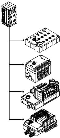
Die Elektrik-Anschaltung CPX-P CTEL-Master erstellt die Verbindung zu Modulen mit I-Port Schnittstelle (Device) der CTEL/CTEU-Familie. Die E/A-Daten der angeschlossenen Devices werden an den angeschlossenen CPX-P-Busknoten und somit über Feldbus an die übergeordnete Steuerung übertragen. Über entsprechende M12-Schnittstellen können maximal 4 Devices an einen CPX-P CTEL-Master angeschlossen werden.
