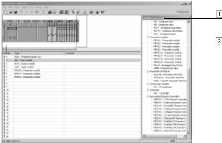
Die Gerätekonfiguration lässt sich komfortabel per drag & drop herstellen, parametrieren und abspeichern. Sie können Module einfügen und verschieben.
