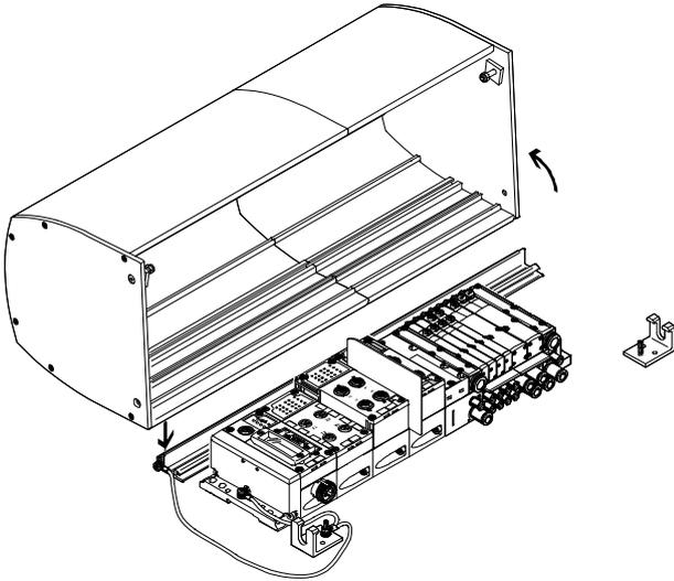
Die CPX-Haube CAFC ist eine platz- und kostensparende Alternative zu einem Schaltschrank. Sie ist als Aluminium-Strangpressprofil ausgeführt und wird auf einer Montageplatte installiert.
