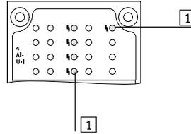
1 Fehler-LED (rot; Modulfehler)
