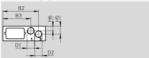
Anschluss 1 und 3, G1/8 links, mit Befestigungsbohrung M4
