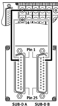
Das Beispiel zeigt die Pin-Belegung Code V12. Bei dieser sind die Ventilspulen in aufsteigender Reihenfolge der Ventile so verschaltet, dass Ventilspule 14 den niederwertigen Pin und Ventilspule 12 den nächstfolgenden Pin jeweils beider Sub-D Anschlüsse belegt:
