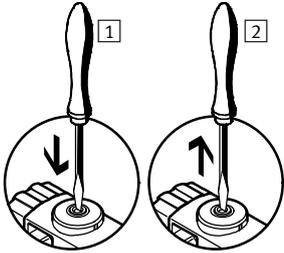
1 Stößel der Handhilfsbetätigung mit einem Stift oder Schraubendreher drücken. Das Ventil schaltet.
