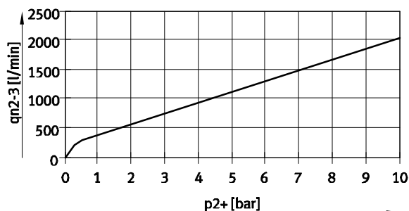
Durchfluss q_n von 2 \rightarrow 3 in Abhängigkeit vom Ausgangsdruck p_2 VPPX-8F-...-0L10H-... (10 bar)
