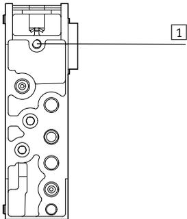
1 Orificio ciego para montaje en el lado posterior
