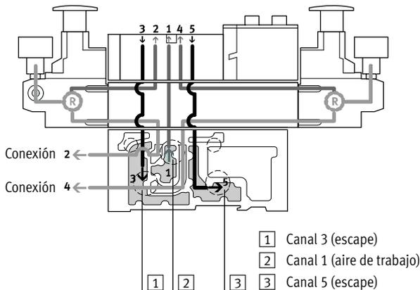
Este regulador de presión permite ajustar la presión en los canales 2 y 4 una vez que el fluido ha atravesado la válvula. Durante la operación de escape, la descarga dentro de la válvula se produce a través del regulador desde el canal 2 hacia el canal 3 y desde el canal 4 hacia el canal 5.
