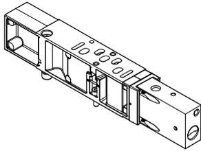
Equipada con un conmutador para bloquear la alimentación de presión. De esta manera es posible sustituir una electroválvula distribuidora o una placa posterior sin desconectar el aire de alimentación. Si la cadena de mando es redundante, el ciclo puede continuar funcionando si el control es monocíclico.
