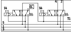
En principio, la función de desconexión del aire de pilotaje se obtiene combinando la placa intermedia tipo VABF-S4-...-S con una electroválvula monoestable de 5/2 vías, tipo VSVA-B-M52-MZD-...-1T1L-APX-0,5. No se alimenta aire de pilotaje al terminal de válvulas a través de la placa final del lado derecho, tipo VABE-S6-1 (código de identificación XS, aire de pilotaje externo). La conexión 14 de la placa final está cerrada.
