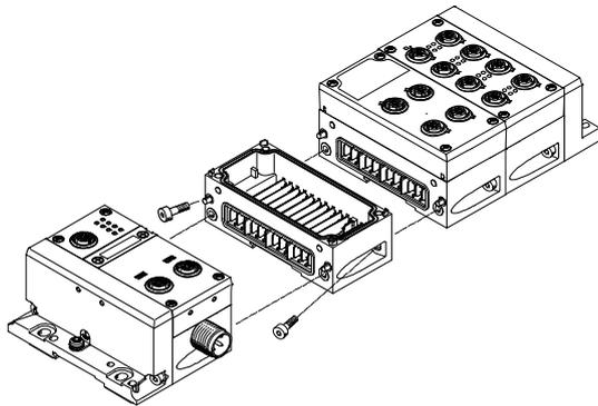
Los módulos CPX de ejecución metálica se unen entre sí mecánicamente mediante tornillos inclinados. De esta manera, el terminal CPX puede ampliarse en cualquier momento.
