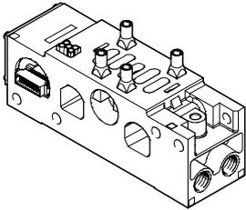
La adaptación al ancho de 65 mm y tamaño ISO 3 se basa en un sistema modular compuesto de placas base y válvulas. Las placas de enlace tienen un canal con junta y un encañamiento eléctrico, están unidas entre sí mediante tornillos y forman el sistema portante para las válvulas. Contienen los conductos
