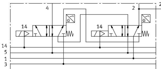
En el bloque de control con función de seguridad VOFA-B26-T52-... para terminal de válvulas, las dos electroválvulas de 5/2 vías (ancho de
