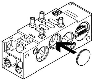
Si se montan discos de aislamiento entre dos placas de alimentación, es posible utilizar presiones de alimentación diferentes, dentro del margen definido por las válvulas de 65 mm de ancho. En ese caso debe
