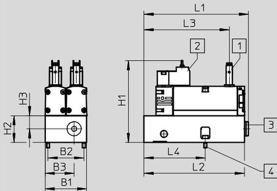
1 Sensor de proximidad PNP o NPN, tamaño M8x1, conexión según EN 61076-2-104
