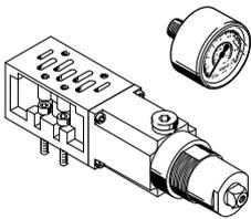
Placa intermedia con regulador de presión integrado para regular la presión en:
