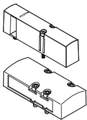
Placa sin función de válvula, para reservar posiciones de válvula en un terminal.
