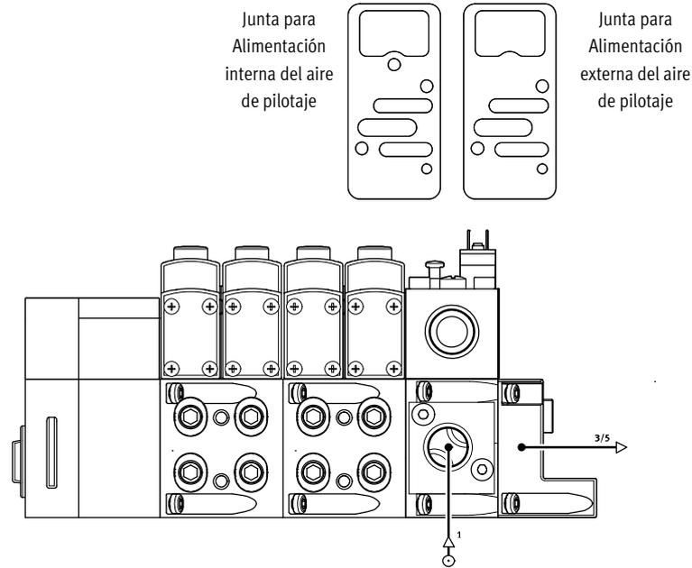
1) En este caso no es posible utilizar una placa final derecha con tapa codificada, ya que no permite la salida del aire de escape
