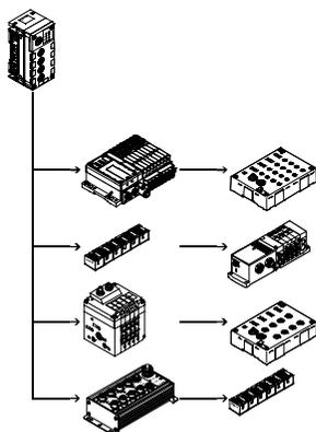
Elektrické připojení rozhraní CPX CP umožňuje pomocí hotových spojovacích kabelů připojit moduly CP instalačního systému CPI. Vstupní/výstupní data připojených ventilových terminálů na větvi CP a modulů vstupů a výstupů CP se přenáší na připojené uzly sítě CPX a tak po síti na nadřazený řídicí systém. Díky tomu lze z modulárních centrálních a kompaktních decentrálních koncepcí sestavit jeden systém. Rozhraní CP je podporováno všemi uzly sítě CPX a jednotkami CPX-FEC a CPX-CEC.
