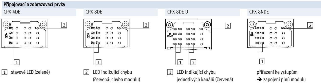
**Kombinace krytů s připojením a digitálních vstupních modulů**
