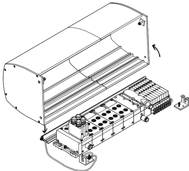
Kryt CPX CAFC je alternativa k rozvaděči, která šetří místo i náklady. Je vyroben jako hliníkový tažený profil a instaluje se na montážní desku. Ventilový terminál (CPX s MPA-S nebo MPA-L) je v namontovaném stavu chráněn a rychle se instaluje, bez nákladného protahování kabelů a hadic do rozvaděče.
