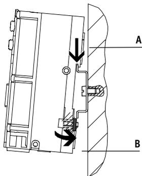
V zadním profilu napájecích bloků CPX je nalisován úchyt pro lištu DIN. Pomocí tohoto připojení lze terminál CPX upevnit na lištu DIN. Ventilový terminál CPX se na lištu DIN zavěsí (viz šipku A).
