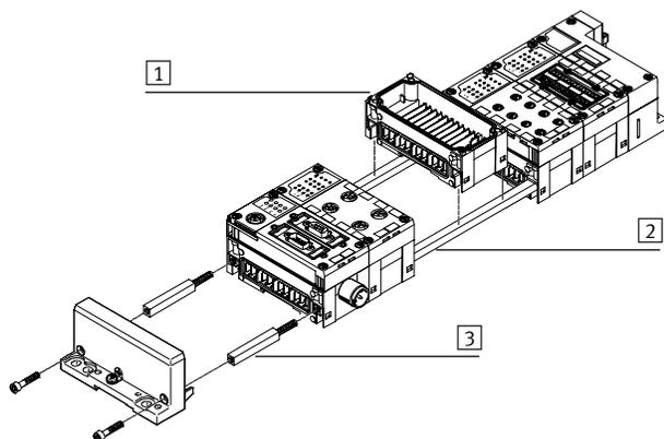
Moduly CPX se vzájemně mechanicky spojují pomocí [2] speciálních svorníků. Celá jednotka se stahuje pomocí pouhých dvou šroubů v koncové desce.
