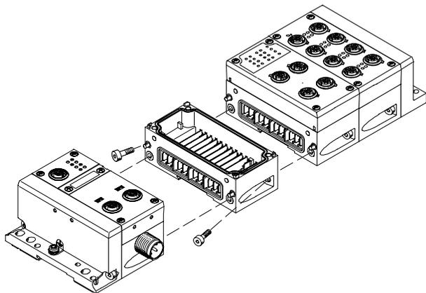
Moduly CPX se vzájemně mechanicky spojují pomocí šikmého spojení šrouby.
