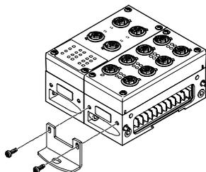
Pro delší ventilové terminály jsou pro terminál CPX k dispozici přídatná upevňovací úhelníky, které lze našroubovat na napájecí bloky. Upevňovací úhelník CPX-M-BG-VT-2X umožňuje upevnit terminál CPX s ventilovým terminálem VTSA/VTSA-F na jeden nosný systém.
