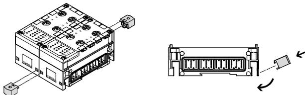
Pro delší ventilové terminály jsou pro terminál CPX k dispozici přídatná upevnění, která lze připevnit mezi dva moduly.
