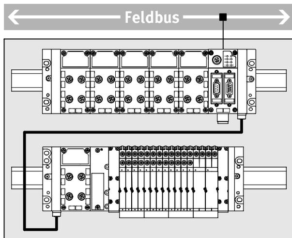
Rozšíření umožňuje rozdělit či konfigurovat terminál CPX do dvou vzájemně propojených jednotek (řady).
