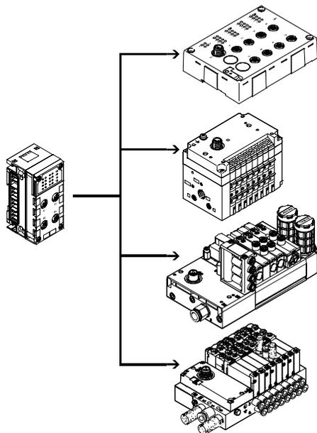
Zařízení CPX CTEL-master nabízí 4 rozhraní I-Port, přičemž ke každému z nich lze připojit zařízení. I-Port je rozhraní pro přenos sériových dat k připojení decentrálních modulů nebo ventilových terminálů Festo. Rozhraní I-Port vychází z technologie IO-Link, takže v určitých oblastech je s ní kompatibilní. Druh propojení odpovídá hvězdicové topologii. To znamená, že na každý I-Port lze připojit pouze jeden modul nebo jeden ventilový terminál.
