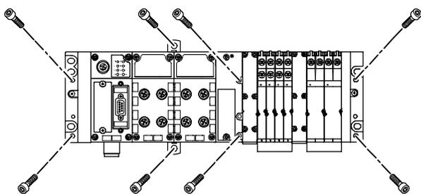
V koncových deskách terminálu CPX, ventilového terminálu a v pneumatickém rozhraní jsou upevňovací otvory pro montáž na stěnu. Pro dlouhé ventilové terminály CPX existují další možnosti upevnění. Tato upevnění se liší podle provedení terminálu CPX (plast nebo kov).
