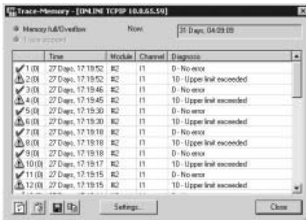
Chyby, které se objeví při provozu, se uloží do diagnostické paměti. Ukládá se prvních nebo posledních 40 záznamů, včetně údaje o času – měřeno od zapnutí napájení.
