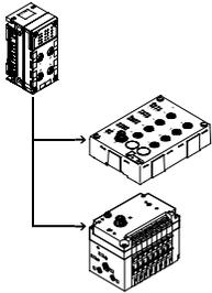
Elektrické připojení CPX-CTEL-2... umožňuje připojit moduly s rozhraním IO-Link (zařízení IO-Link) k terminálu CPX. Vstupní/výstupní data připojených zařízení se přenášejí na připojený síťový uzel CPX a pak po síti do nadřazeného automatu.
