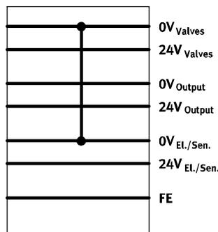
Modul propojuje potenciál 0 V napájení pro elektroniku a čidla s potenciálem 0 V napájení pro ventily. Pokud chcete, aby ventily připojené napravo od pneumatického rozhraní CP byly všemi póly odpojeny, musíte napravo od rozhraní CP použít odpovídající napájecí blok s přídatným napájením ventilů.
