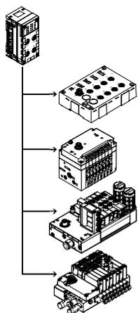
Elektrické připojení CPX CTEL-Master zajišťuje propojení k modulům s rozhraním I-Port (zařízením) z řady CTEL/CTEU. Vstupní/výstupní data připojených zařízení se přenášejí na připojený síťový uzel CPX a pak po síti do nadřazeného automatu.
