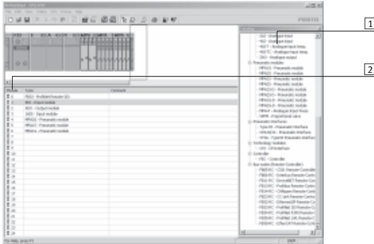
Konfiguraci zařízení lze vytvořit, parametrizovat a uložit pohodlně pomocí funkcí drag & drop. Moduly můžete vkládat a posouvat.
