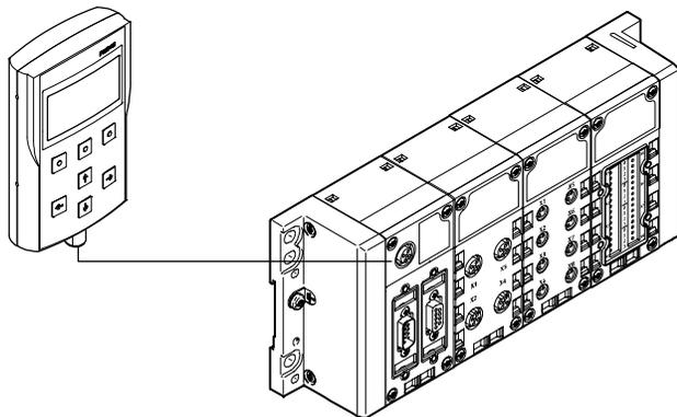
Ovládací jednotka se k terminálu CPX připojuje spojovacím kabelem.
