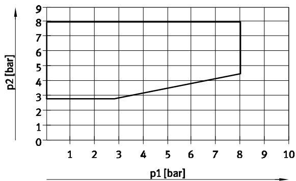
Pilotaje en función de la presión de funcionamiento (presión de funcionamiento con aire de pilotaje exterior), presión de mando 5/2 y 3/2U
