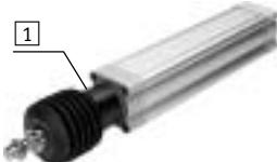
Sada s měchem je systém bez úniků. Přívod a výstup sady je v připojovací části [1] opatřen otvorem pro vyrovnávání tlaků, aby nedocházelo k nežádoucímu nasávání médií.
