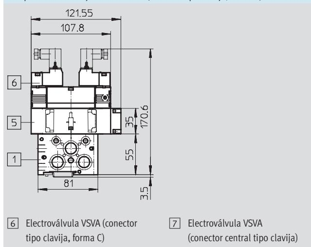
[6] Electroválvula VSVA (conector tipo clavija, forma C)
