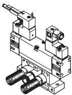
La válvula de vías está servopilotada según ISO 15218 y tiene un patrón de conexiones según DIN EN 175301-803, forma C.
