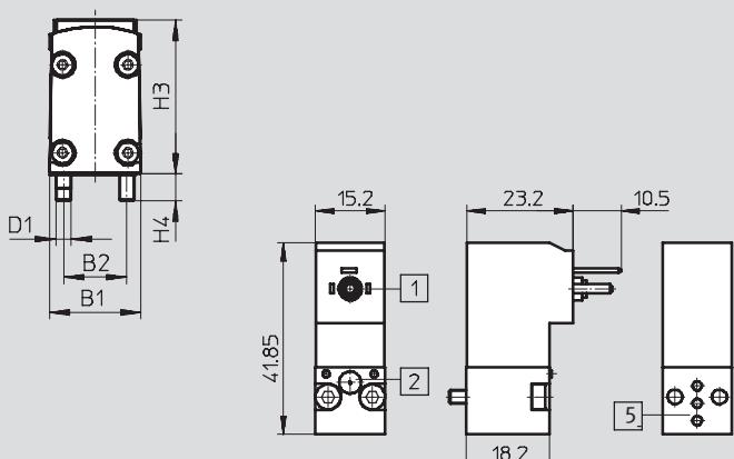
[1] Conexiones según DIN EN 175301-803, forma C
