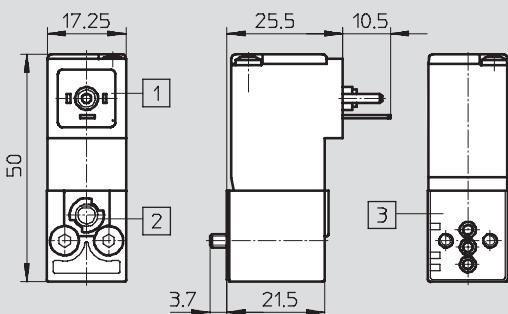
[1] Conexiones según DIN EN 175301-803, forma C
