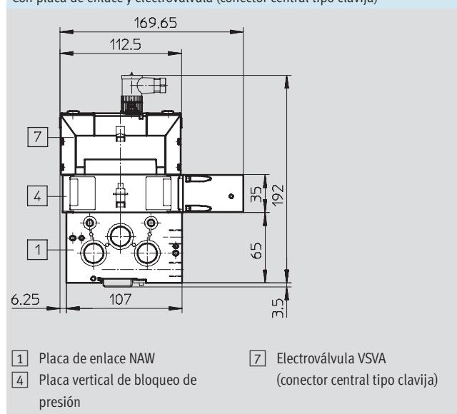
Con placa de enlace y electroválvula (conector tipo clavija, forma C)
