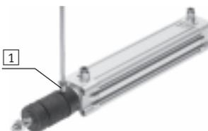
El fuelle no tiene fugas. Con el fin de evitar la aspiración de fluidos no apropiados, la pieza de conexión **1** tiene un taladro para alimentación y descarga común del aire. Esta solución protege el vástago, la junta y la culata frente a fluidos
