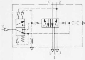
Das Ventil besteht aus einem 5/2-Wege-Grundventil mit angebaubem Unter-setzer-Element. Ein Signal bei Anschluß 14 schaltet das Ventil um und sperrt den Unter-setzerkolben. Nach Signalende wird der Unter-setzerkolben durch eine Feder bzw. über Ausgang 2 so umge-steuert, daß das nächste Steuersignal das Zurückschalten des Ventils bewirkt. Bis zu dessen Eintreffen behält das Grundventil seine Schaltstellung bei. Das bedeutet, bei jedem Signal auf 14 wechselt das Ausgangssignal bei 4 und 2.
