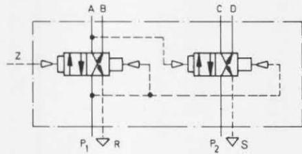
Mit diesem Ventil können Funktionen von Festo Taktvorschubgeräten, wie Vorschubbewegungen und wechselweises Spannen, gesteuert werden.
