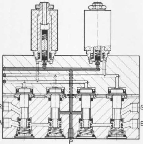
Diese Ventile halten in Nullstellung den Kolben eines doppelwirkenden Zylinders unter Druck eingespannt.
