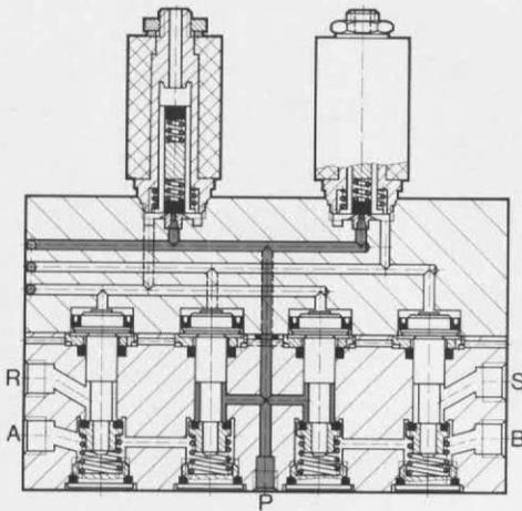
Diese Ventile halten in Nullstellung den Kolben eines doppeltwirkenden Zylinders unter Druck eingespannt. Sie eignen sich daher speziell zur Positionierung, zum Stoppen bei Not-Halt und zum Festhalten von doppeltwirkenden Zylindern in jeder beliebigen Stellung.
