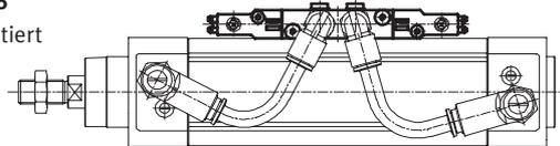
Monostabiles Ventil unbetätigt, Kolbenstange ausgefahren
