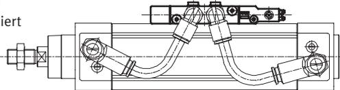
Bistabiles Ventil unbetätigt, Kolbenstange eingefahren
