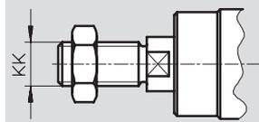
K7 – Kolbenstange mit Außensechskant
