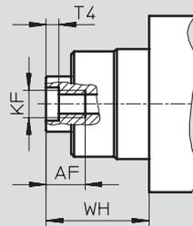
K5 – Sondergewinde an der Kolbenstange
