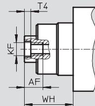
**K5 – Sondergewinde an der Kolbenstange** **K7 – Kolbenstange mit Außensechskant**
