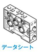
値 特長 18 mm 規格 ISO 15407-1 作動流体 ISO8573-1:2010 [7:4:4]準拠の圧縮エア 作動/パイロット流体に注意 給油運転可能(継続運転に必要 PWIS conformity VDMA24364-B1/B2-L 130 g パイロット接続ポート12 M5 パイロット接続ポート14 М5 エア接続ポート2 G1/8 エア接続ポート4 G1/8 アルミダイカスト Material of connecting plate
