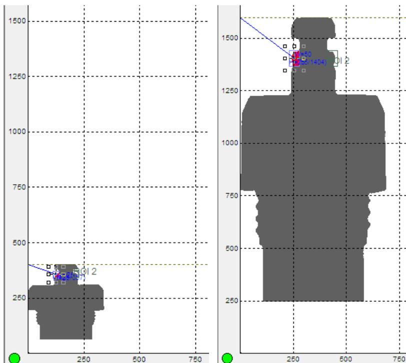
Am besten zeigt sich die Verbesserung der Auflösung, wenn man die Werte der ROI vergleicht. links mit kleiner Auflösung wird das Vorhandensein eines O-Ring mit ca. 300 Pixel geprüft. In der in beiden Richtungen verbesserten Auflösung, mit Anpassung der Position und Größe, wird der ROI mit ca. 2200 Pixel überprüft. Die Auswertung wird dadurch sicherer und stabiler.
