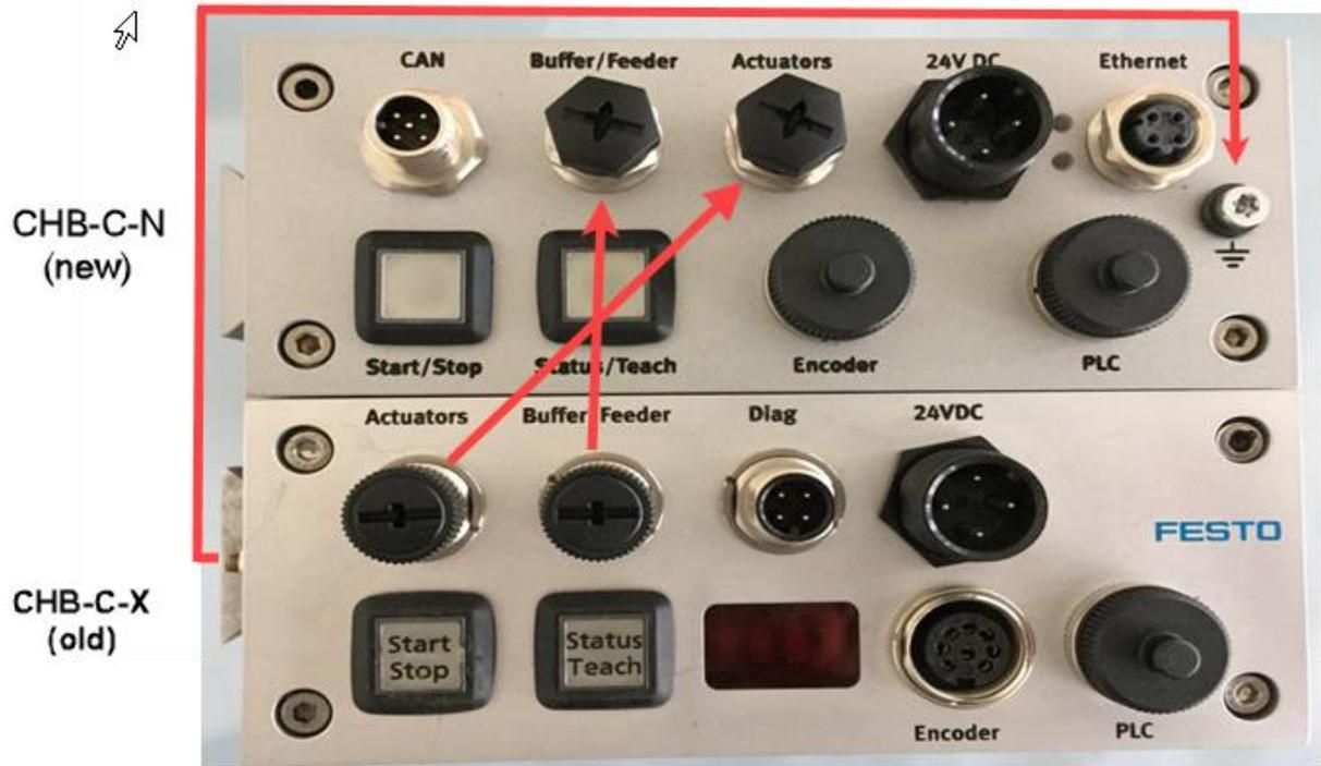
Der Erdanschlusspunkt PE befindet sich beim neuen Gerät auf der Frontplatte. Hier ist zu prüfen ob die vorhandene Länge der PE-Leitung ausreicht. Gegebenenfalls muss die Leitung angepasst werden.
