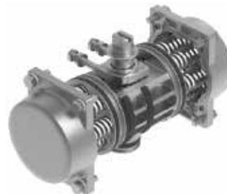
单作用角行程驱动器利用进入的压缩空气推动活塞向一个方向移动，从而产生驱动器的扭矩。同时，驱动器内置的弹簧被预紧。当驱动器的压力室排气时，这种弹簧力会产生相反旋转方向的扭矩，从而使角座阀移动到所需的初始位置。
