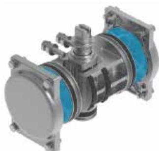
双作用角行程驱动器在每个运动方向上都需要压缩空气。在这种工作模式下，开启或关闭过程阀所需的扭矩完全由压缩空气产生。
