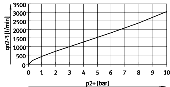
Prietok q_n z 1 \rightarrow 2 v závislosti od výstupného tlaku p_2 VPPX-8L-...-0L10H-... (10 barov)
