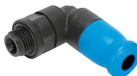
Racor de plástico para una instalación sencilla gracias al manejo con una sola mano. Resistente a la hidrólisis, conforme con las especificaciones de la FDA y de fácil limpieza. Para aplicaciones neumáticas con un margen de temperatura de hasta 60 °C y un margen de presión de hasta 10 bar. Diámetro exterior del tubo flexible de 6 mm con rosca de conexión G1/8.
