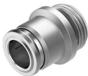
Racor rápido roscado de acero inoxidable. Máxima resistencia a la corrosión CRC 4 y a sustancias químicas. Para aplicaciones neumáticas con un margen de temperatura de hasta 150 °C y un margen de presión de hasta 16 bar.
