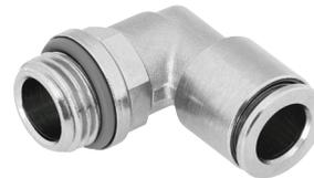
Racor metálico de latón macizo, niquelado químicamente. Resistencia a la corrosión elevada CRC 3 y a las sustancias químicas. Para aplicaciones neumáticas con un margen de temperatura de hasta 150 °C y un margen de presión de hasta 20 bar.
