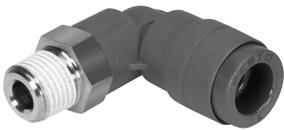
Racor rápido roscado ignífugo para la utilización en cualquier zona con peligro de incendio, por ejemplo, en equipos de soldadura en la industria automovilística o en el sector de la construcción. Para aplicaciones neumáticas con un margen de temperatura de hasta 60 °C y un margen de presión de hasta 10 bar.
