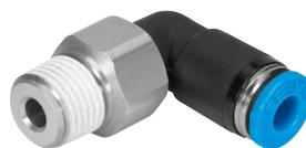
Racor rápido roscado con junta basculante, orientable 360°. El cojinete de bolas permite movimientos giratorios de hasta 500 rpm. Para aplicaciones neumáticas con un margen de temperatura de hasta 60 °C y un margen de presión de hasta 14 bar.
