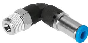
El racor rápido roscado bloquea el flujo de aire después de soltarse el tubo flexible. Para aplicaciones neumáticas con un margen de temperatura de hasta 60 °C y un margen de presión de hasta 14 bar.
